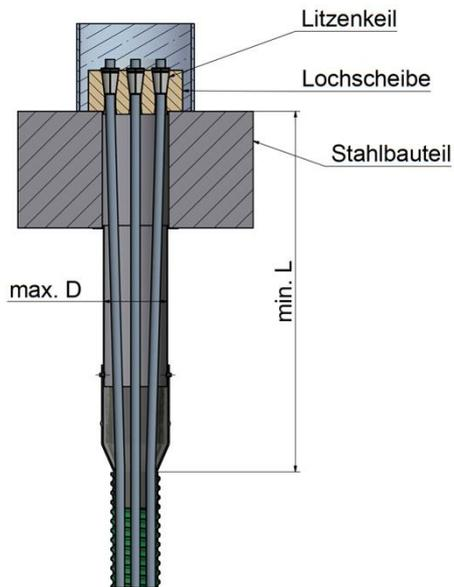
Das Stahlbauteil ist nach technischen Baubestimmungen zu bemessen. Vorgegeben ist der Durchmesser der Bohrung im Stahlbauteil zum Aufsetzen des Festankers (siehe untenstehende Tabelle).
