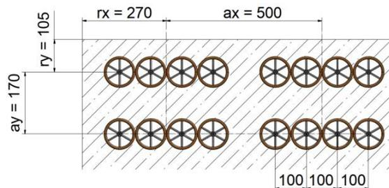
Es dürfen auch 2x14 Ø8 Steckbügel verwendet werden, die mit  $l_s = 420 \text{ mm}$  zu übergreifen sind.
