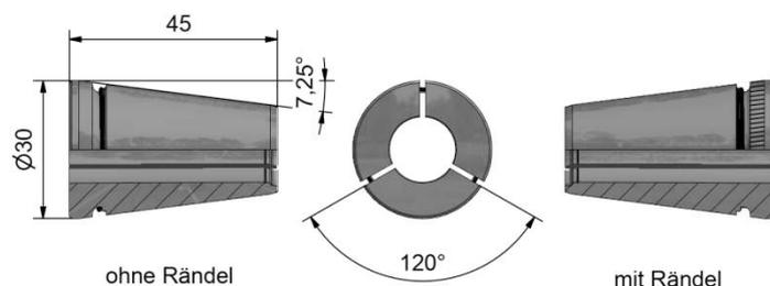
Bei vorverkeiltten Festankern sind wahlweise Keile mit Rändel verwendbar.
