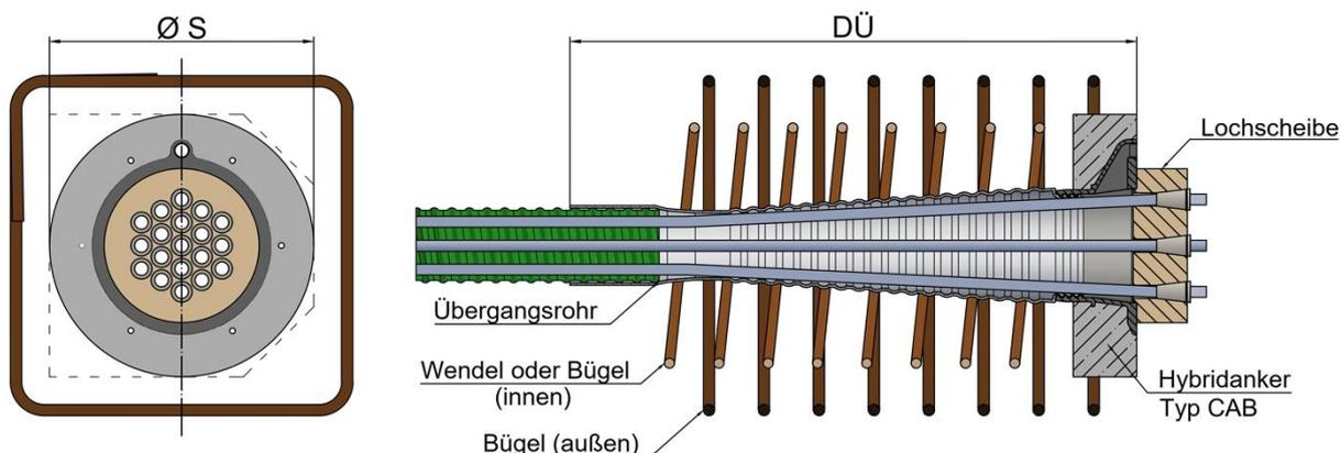
Spanngliedtyp BBV L3 i – L27 i, Spannanker und Festanker mit Hybridankerplatte (Seitenlänge S) und Lochscheibe. Bügel außen (oder entsprechende kreuzende Bewehrung) sind immer erforderlich. Die innere Bewehrung (Wendel oder Diagonalbügel) sind optional und können auch durch mehr Bügel außen ersetzt werden (siehe Anlage 7, Seite 1).
